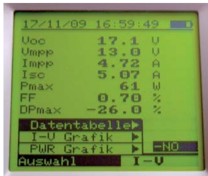
Das I-V 400 verfügt über eine grosse grafische Anzeige, von der alle notwendigen Messwerte gleichzeitig abgelesen werden können, um die Qualität der Solarmodule zu bestimmen
