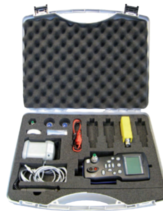
Hand-Held Druckkalibrator mit Servicekoffer
