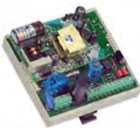
Trafo auf Hutschiene
