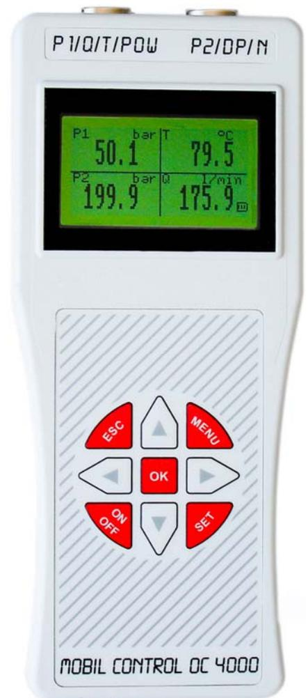
OC4000 ist in einem Handgehäuse untergebracht und aus interner wiederaufladbarer Batterie versorgt. Die Ladezeit wird mit einer LED signalisiert, automatisch durch den Controller überwacht und zeitlich limitiert. Mit einem Netz-Ladegerät kann die Batterie auch während des Betriebs geladen werden. Als Option ist ein spezielles Kabel zur Versorgung aus 12V oder 24V Autobatterie erhältlich.
