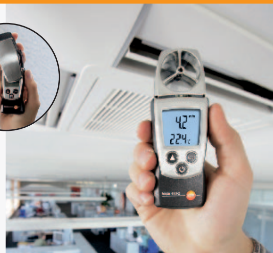
Strömungsmessung am Kanalauslass mit 40 mm-Flügelrad
