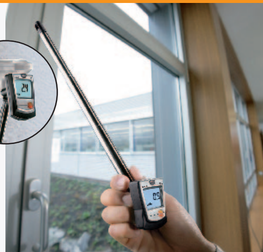
Strömungsmessung an undichten Fenstern
