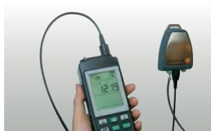
Überprüfung von Messwert-Umformern mit 4...20 mA-Interface
