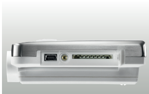
Seitlicher Anschluss von Mini-USB-Kabel und SD-Karte
