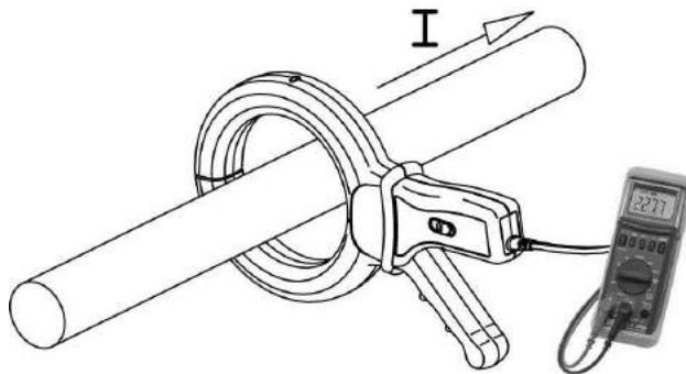
**Figure 3 :** Principe d'utilisation de la pince ampèremétrique B102.
