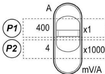
Abbildung 14: Position des Stromleiters.
