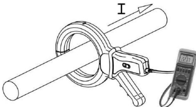
**Figura 21** : Principio d'utilizzazione della pinza amperometrica B102.
