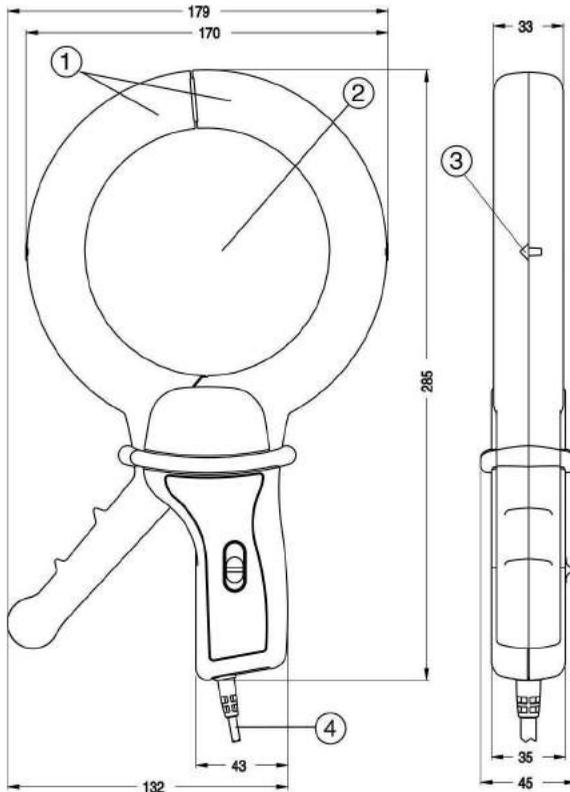
**Abbildung 13** : Abmessungen und Messstellen der B102 Zange.
