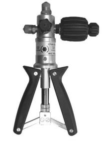
Diese Arbeiten können im Labor oder Werkstatt stattfinden. Besonders bei Ort-Anwendungen ist die portable Druckpumpe von Vorteil. Es sind weder Stromversorgung noch Druckflasche notwendig. Die Kalibrierpumpe ist so entwickelt, dass alle Messgeräte direkt zum Kalibrieren angeschlossen werden können über Minimess-Schnellkupplungen.
