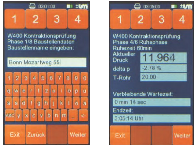
Bild 1: Eingabe der Prüfungsdaten über eine vollwertige Tastatur. Prüfverlauf W400-2, Teil 16
