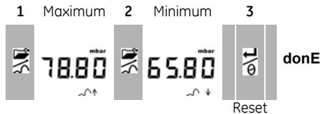
Schritt **3** setzt die Werte für das Maximum/Minimum zurück. Drücken und halten Sie die Taste gedrückt.
