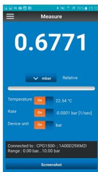
Über die App „myWIKa device“ und die Bluetooth®-Verbindung lässt sich das CPG1200 per Handy bequem für Kalibrier- und Log-Aufgaben konfigurieren. Während der Druckmessung wird der Wert in der benötigten Einheit direkt auf dem Handy angezeigt.
