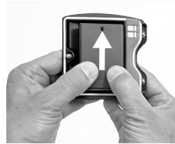
Abb. 10: Entfernen des Batteriefachdeckels
