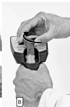
Abb. 9: A: Lösen einer verriegelten Pumpe | B: Wiedereinsetzen der Pumpe
