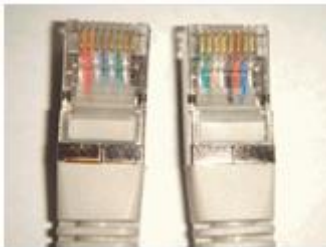
Crossover-Kabel mit RJ45-Stecker
