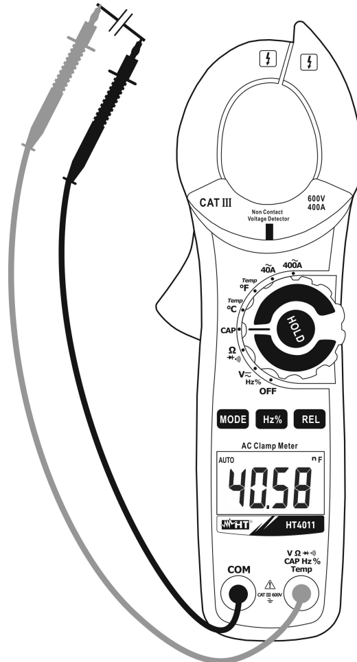
Abb. 6: Verwendung der Zange für Kapazitätsmessung
