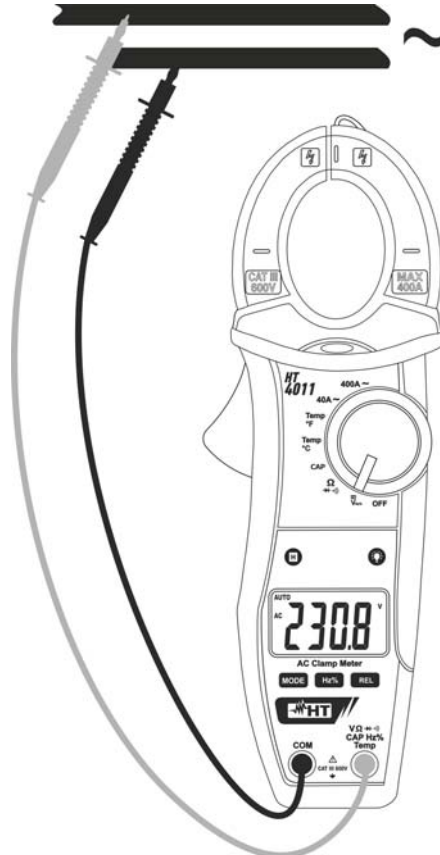
Abb. 4: Verwendung der Zange für Wechselspannungsmessung
