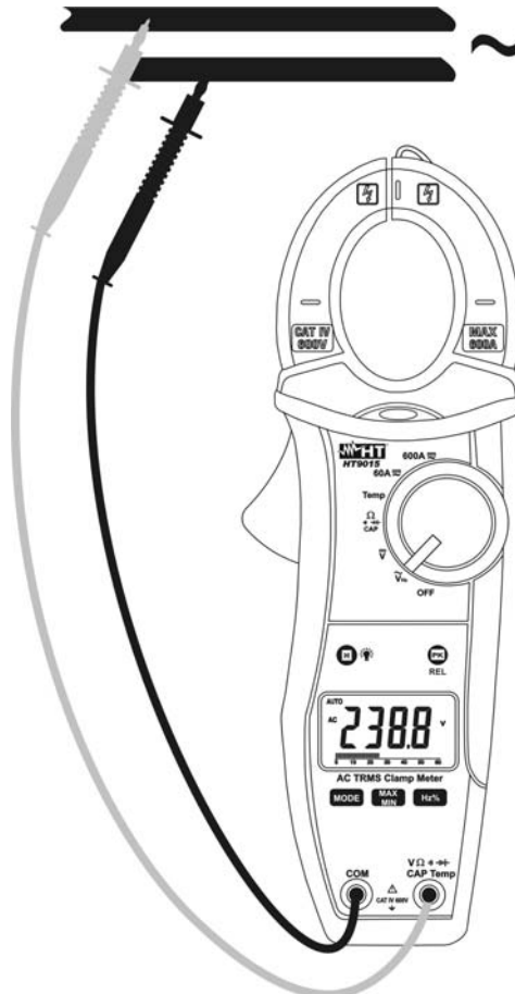
Fig. 3: Uso de la pinza en medidas de Tensión CA
