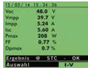
Messwertergebnis in Funktion I-U Kennlinienmessung
