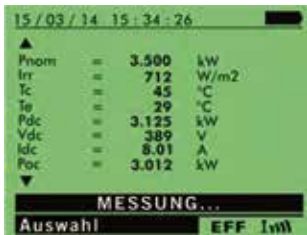
Messung / Aufzeichnung in der Funktion Leistungsanalyse
