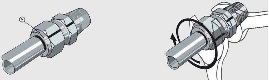
Fixierung der Klemmverschraubung
