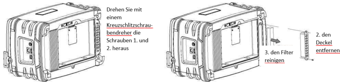
Abbildung 8- 4 Montage und Demontage des Luftfilters
