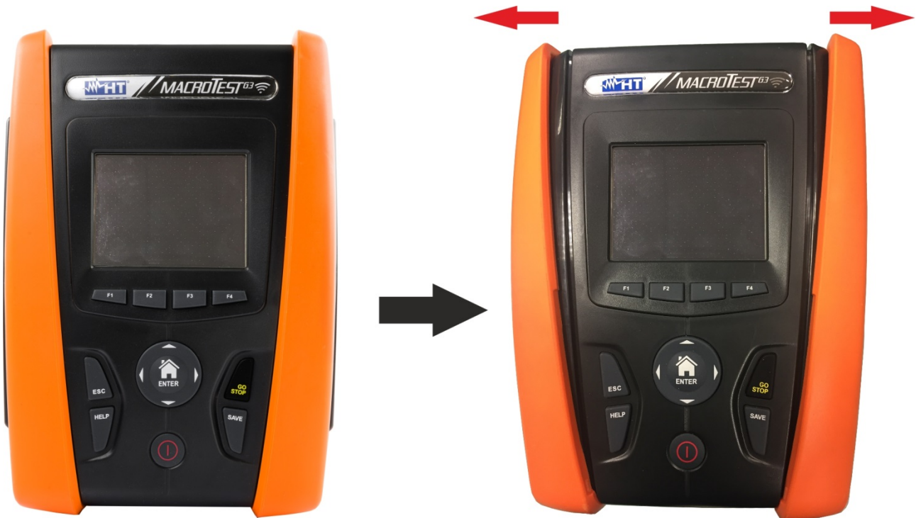
Abb. 40: Entfernen des linken und rechten Gummischutzholsters
