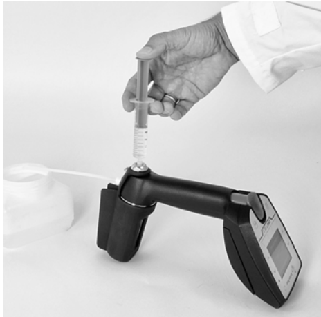
Abb. 10: Einfüllen der Probe mit einer Spritze
