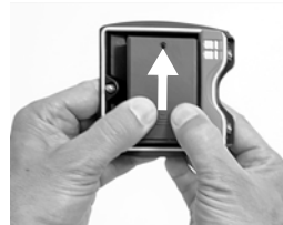
Abb. 15: Entfernen des Batteriefachdeckels
