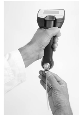
Abb. 3: Anschließen des Saugrohrs
