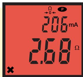
Durchgangsmessung mit 200 mA und Messwert  $> 2 \Omega$
