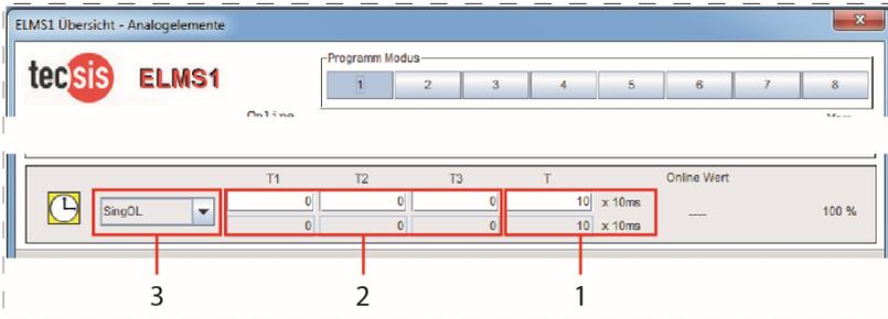
Fig. 30 ELMS1 Übersicht – Analogelemente – Abschaltverzögerungen
