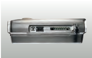
Seitlicher Anschluss von Mini-USB-Kabel und SD-Karte
