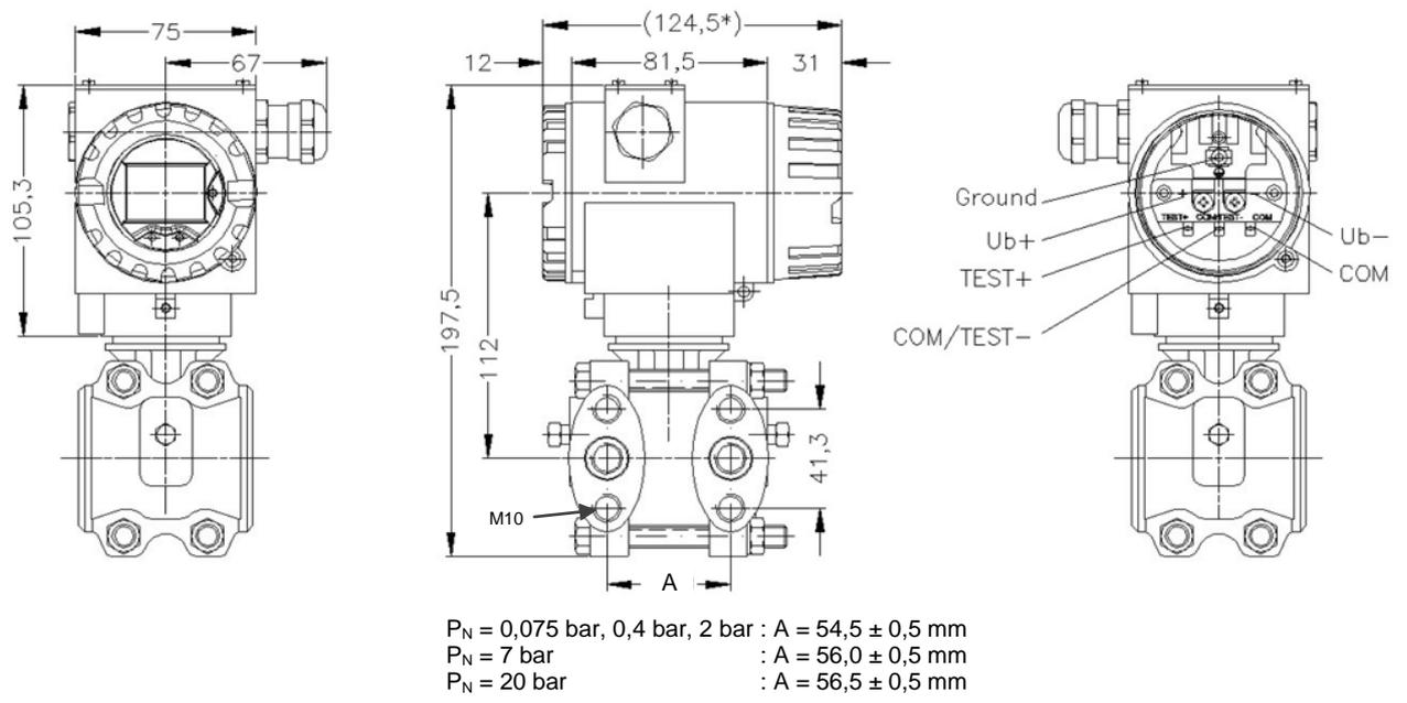
\* ohne Anzeige- und Bedienmodul verringern sich die gekennzeichneten Maße um 19 mm
