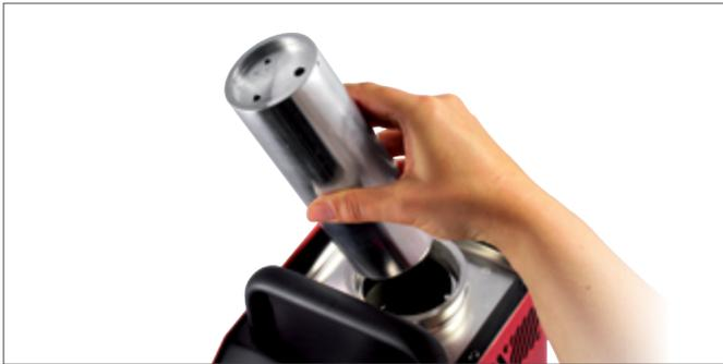
Die Trockenblockfunktion wurde entwickelt, um eine einfachere Kalibrierung der Temperatur im Labor- und Feldeinsatz zu gewährleisten. Die optimale thermische Ankopplung von Block zu Prüfling wird durch die richtige Übergangshülse erreicht. Der Trockenblock deckt den gesamten Temperaturbereich ohne Wechsel des Kalibriermediums ab. Der Anwender muss keine Rücksicht auf Viskositäten, Flammpunkte oder Ausgasungen nehmen.
