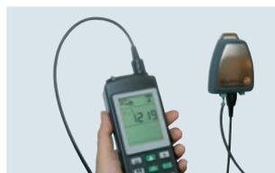
Überprüfung von Messwert-Umformern mit 4...20 mA-Interface
