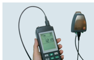
Überprüfung von Messwert-Umformern mit 4...20 mA-Interface
