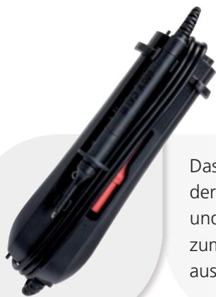
Das Gehäuse liegt perfekt in der Hand, bietet Schutzart IP54 und ist mit einer Aufnahme zum Einclipen der Prüfspitzen ausgestattet.
