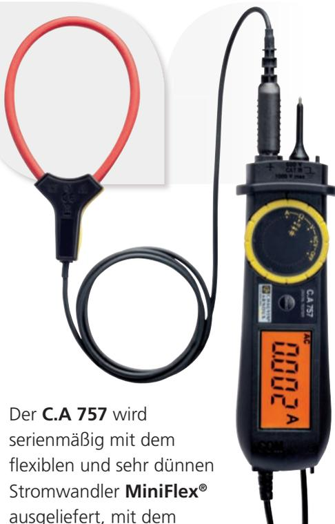
Der **C.A 757** wird serienmäßig mit dem flexiblen und sehr dünnen Stromwandler **MiniFlex®** ausgeliefert, mit dem Strommessungen bis 300 A auch an schwer zugänglichen Leitern möglich sind.
