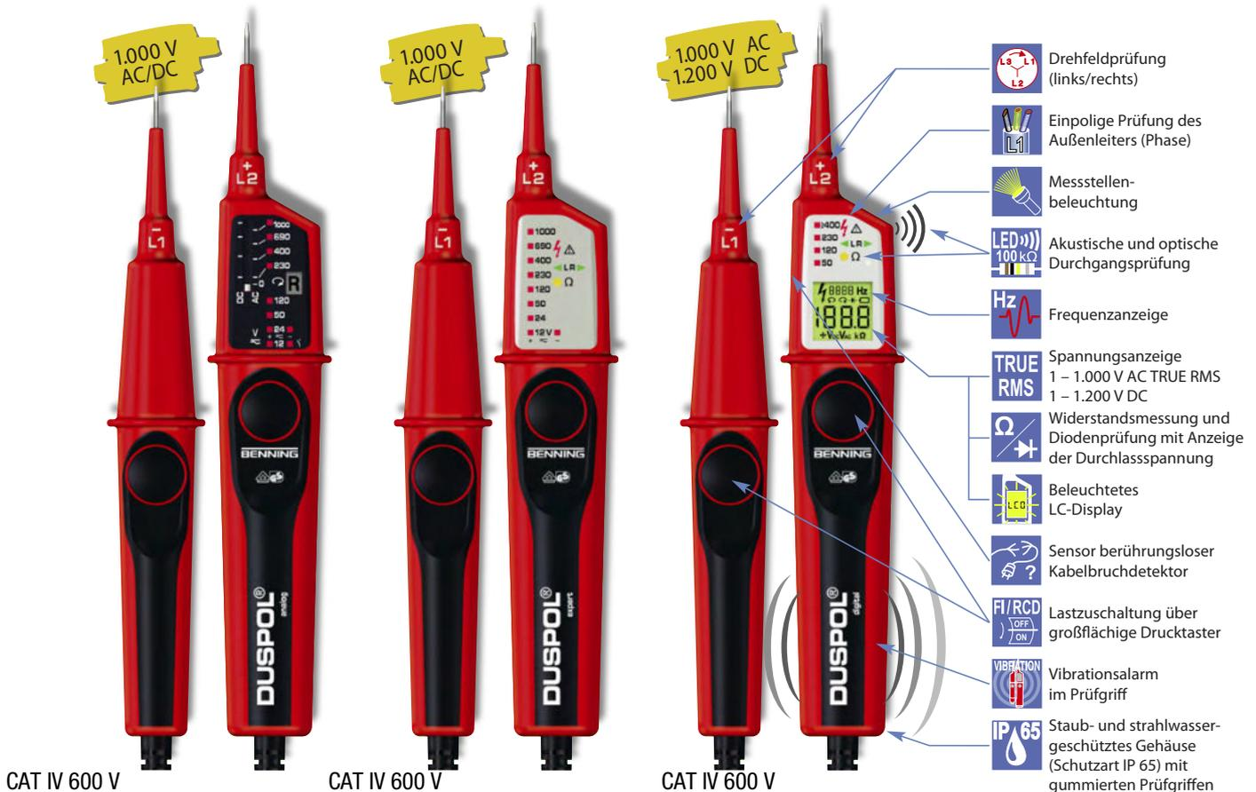
Alle DUSPOL®-Spannungsprüfer besitzen ein direktes Anzeigesystem mit geringer Belastung der Prüfstelle. Im Bedarfsfall kann ein Lastkreis über Drucktaster zugeschaltet werden, der induktive und kapazitive „Blindspannungen“ unterdrückt. Somit kann eindeutig zwischen energiereichen und energiearmen Stromkreisen unterschieden werden.
