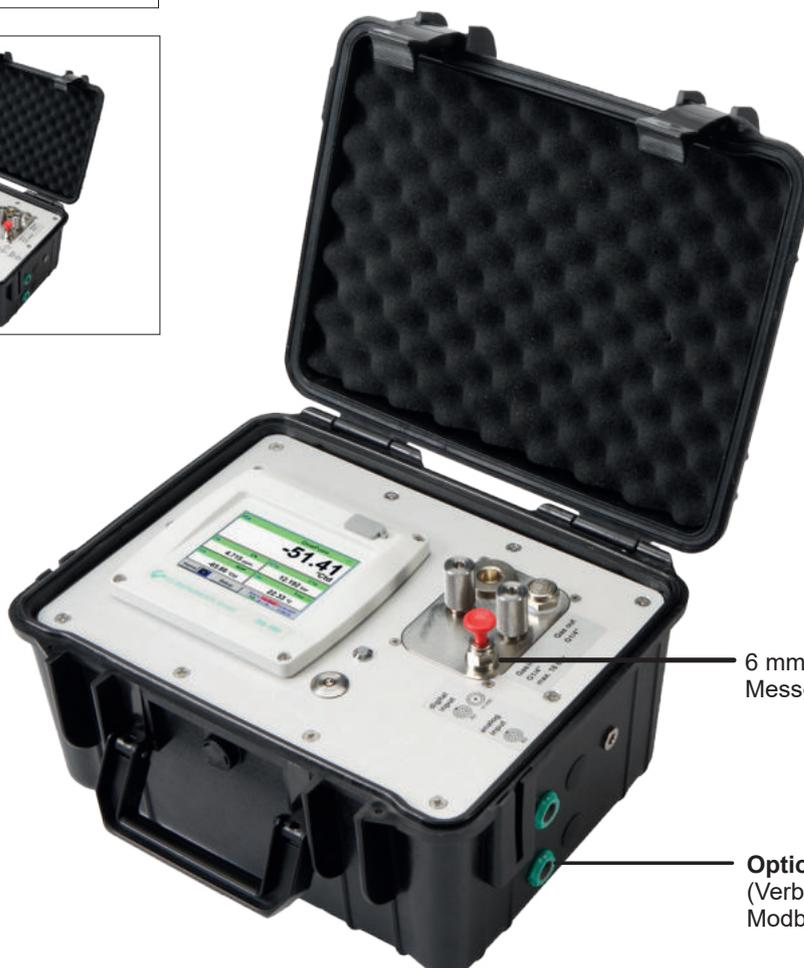
6 mm Steckanschluss zur Messgas-/ Druckluft Zuführung
