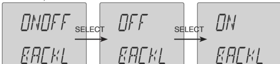
Die Hintergrundbeleuchtung kann auf «ONOFF», «ON» oder «OFF» gesetzt werden. «ONOFF» aktiviert die automatische Ausschaltfunktion, welche die Hintergrundbeleuchtung bei Berührung aktiviert und 10 Sekunden nach der letzten Tastenbetätigung ausschaltet.
