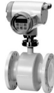
Messaufnehmergehäuse und Flansche sind in Kohlenstoffstahl (ASTM A 105), der Klemmkasten ist in glasfaserverstärktem Polyamid oder optional in Edelstahl (AISI 316) ausgeführt. Das Messrohr besteht aus Edelstahl (AISI 304) und die Auskleidungen und Elektroden sind in einer Vielzahl verschiedener Werkstoffe verfügbar, wodurch der Messaufnehmer hoch beständig ist gegen eine große Bandbreite von Chemikalien.
