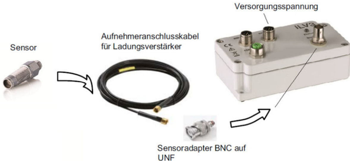
Abb. 5: Messkette mit Sensor, Kabel und ILV 3 (Beispiel)
