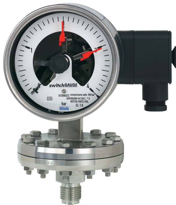
Plattenfedermanometer mit Schaltkontakten, Typ 432.56.100, hochüberlastsicher bis 40 bar
