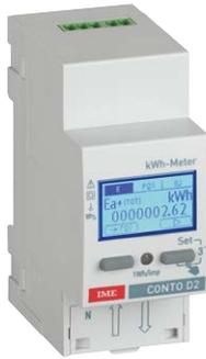
Energiezähler mit Direktanschluss für Einphasennetze bis 63A (ohne MID). Erfassung und Anzeige von positiver / negativer Wirk- & Blindenergie, sowie von weiteren Netzparametern, als Doppeltarifzähler oder mit Impulszähleingang. Für Managementsysteme bietet sich bei Modellen mit RS485 Modbus RTU Schnittstelle die Möglichkeit, die Energiemengen und alle sonstigen elektrischen Messgrößen zu übertragen.
