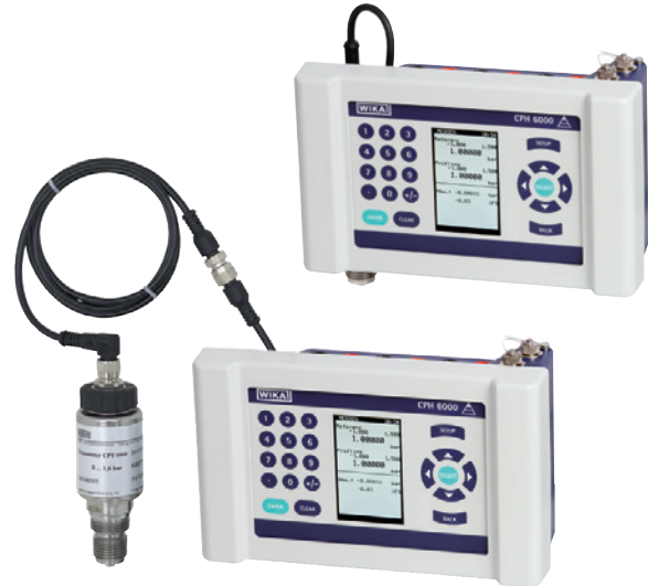
Druckkalibrator, Typ CPH6000 Oben: Mit fest montiertem Referenzdrucksensor Unten: Referenzdrucksensor via Sensoranschlusskabel
