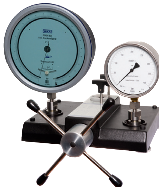
Kalibrieraufbau CPP1200-X mit Feinmessmanometer als Referenzgerät und Prüfling
