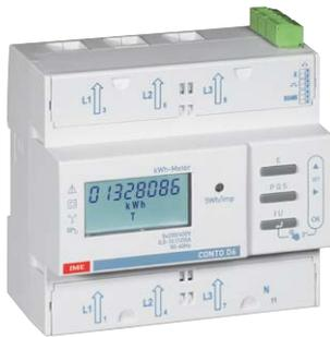
Energiezähler mit Direktanschluss für Netze mit 3 oder 4 Leitern bis 125A und MID-Zertifizierung. Doppeltarifzähler zur Erfassung und Anzeige aller wichtigen Netzparameter und Übertragung der pos. Wirk- oder Blindenergie über S0-Impuls. Für Managementsysteme bietet sich bei Modellen mit RS485 Modbus RTU Schnittstelle die Möglichkeit, die Energiemengen und alle sonstigen elektrischen Messgrößen zu übertragen.
