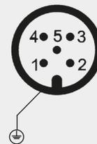
Den Kabelschirm mit dem Gehäuse des Kraftaufnehmers verbinden.
