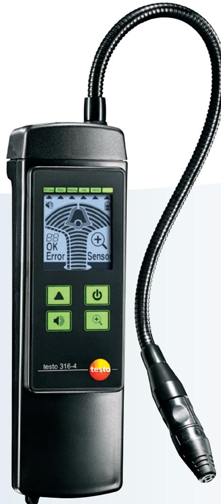
Das testo 316-4 (Set 1) ist ein schnelles und zuverlässiges Lecksuchgerät für alle gängigen Kältemittel. Der Sensor wird permanent überwacht und zeigt im Display Fehlfunktionen oder Verschmutzungen an. Der Einsatz von Testlecks erübrigt sich somit. Bei Verschmutzung kann der Sensor einfach gereinigt werden und ist sofort wieder einsatzbereit.
