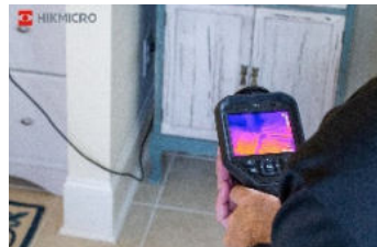
Überprüfung von Fußbodenheizungen
