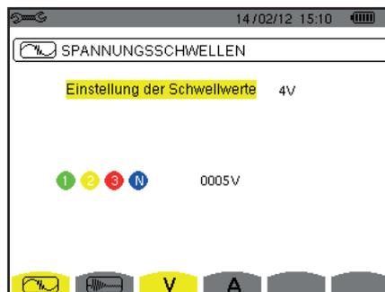
Abbildung 28: Bildschirm Spannungsgrenzwerte im Menü Transienten-Modus
