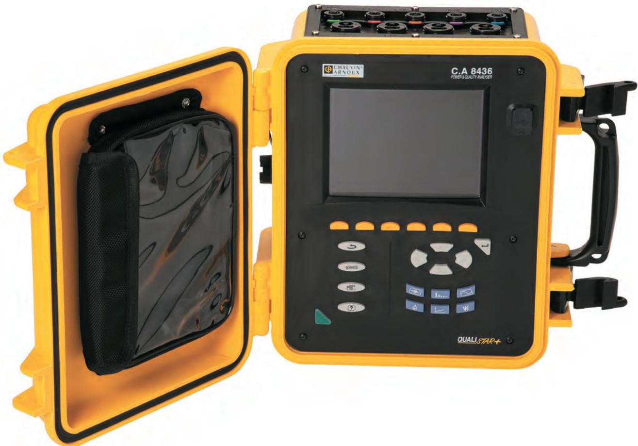
**Analysator für Drehstromnetze**
