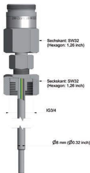
Bild 2: Temperatursensor Tauchhülse
