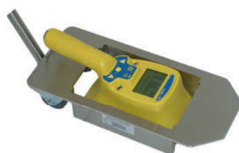
CoMo in a floor control device
