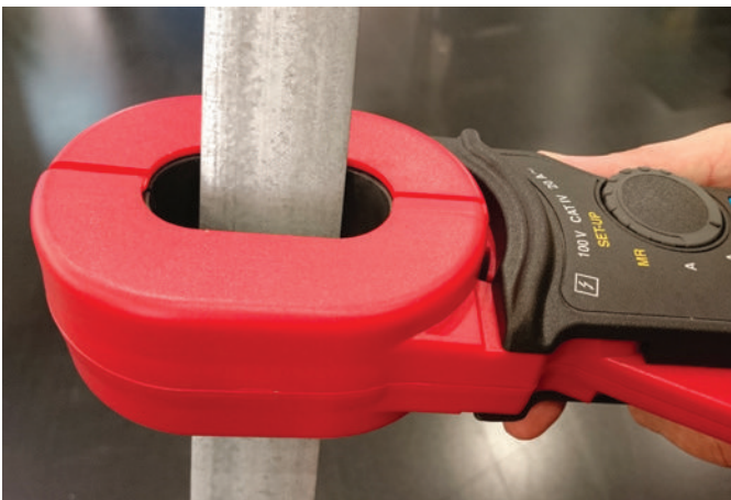
Messung an Bänderder mit CA 6418 dank länglichem Messkopf
