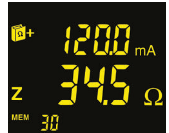
1. Anzeige: Impedanz und Ableitstrom
