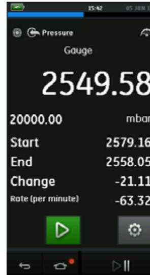
**Max/Min** – erfasst Maximal- und Minimalwerte und berechnet den Mittelwert.
