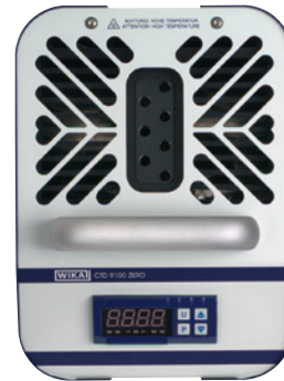
Abb. 2: Temperaturblock mit den sieben Prüfbohrungen
