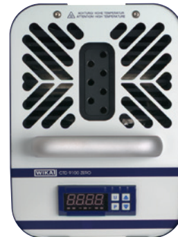
Fig. 2: Bloque de temperatura con las siete perforaciones de prueba
