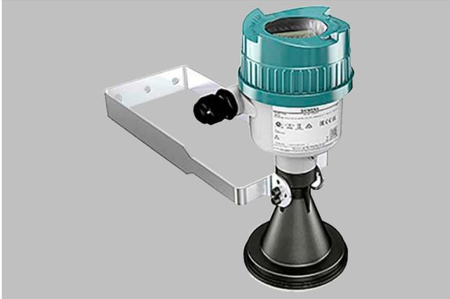
Der SITRANS LR550 mit Hornantenne aus Polymer ermöglicht die kontinuierliche Überwachung von Schüttgütern oder Flüssigkeiten für Messbereiche bis 120 m (394 ft). Die Leichtbauweise eignet sich für Freifeldanwendungen, zur Bestandsmessung von Grundstoffen in Silos und Behältern oder zur Überwachung des Flusspegels.
